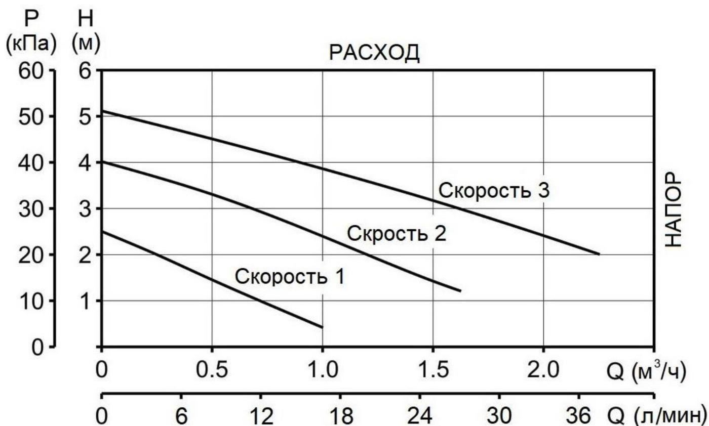
Рис. 17 Напорно-расходные кривые циркуляционного насоса электродкотла.
