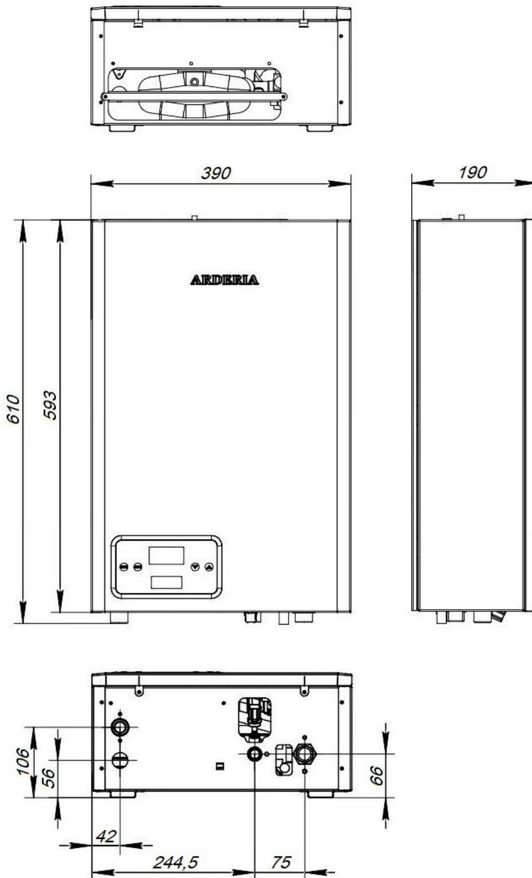
Рис. 3 Габаритные размеры
