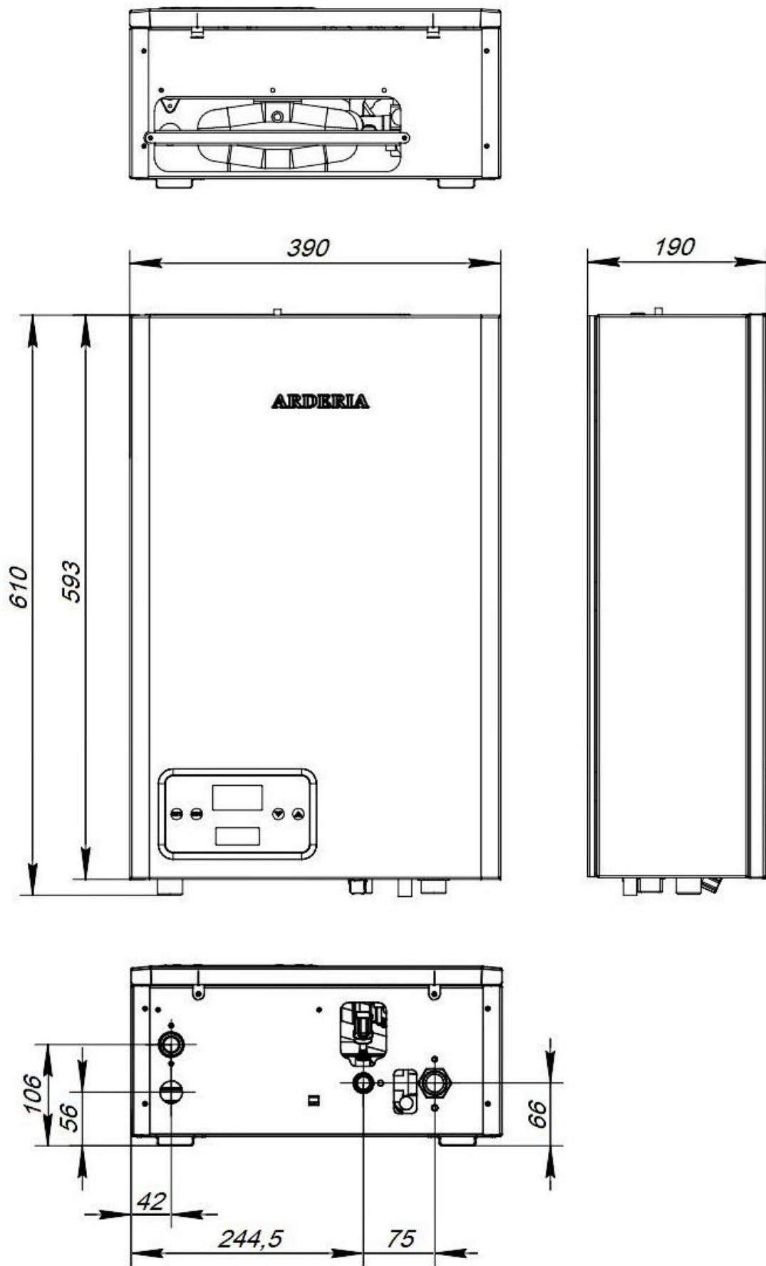
Рис. 3 Габаритные размеры
