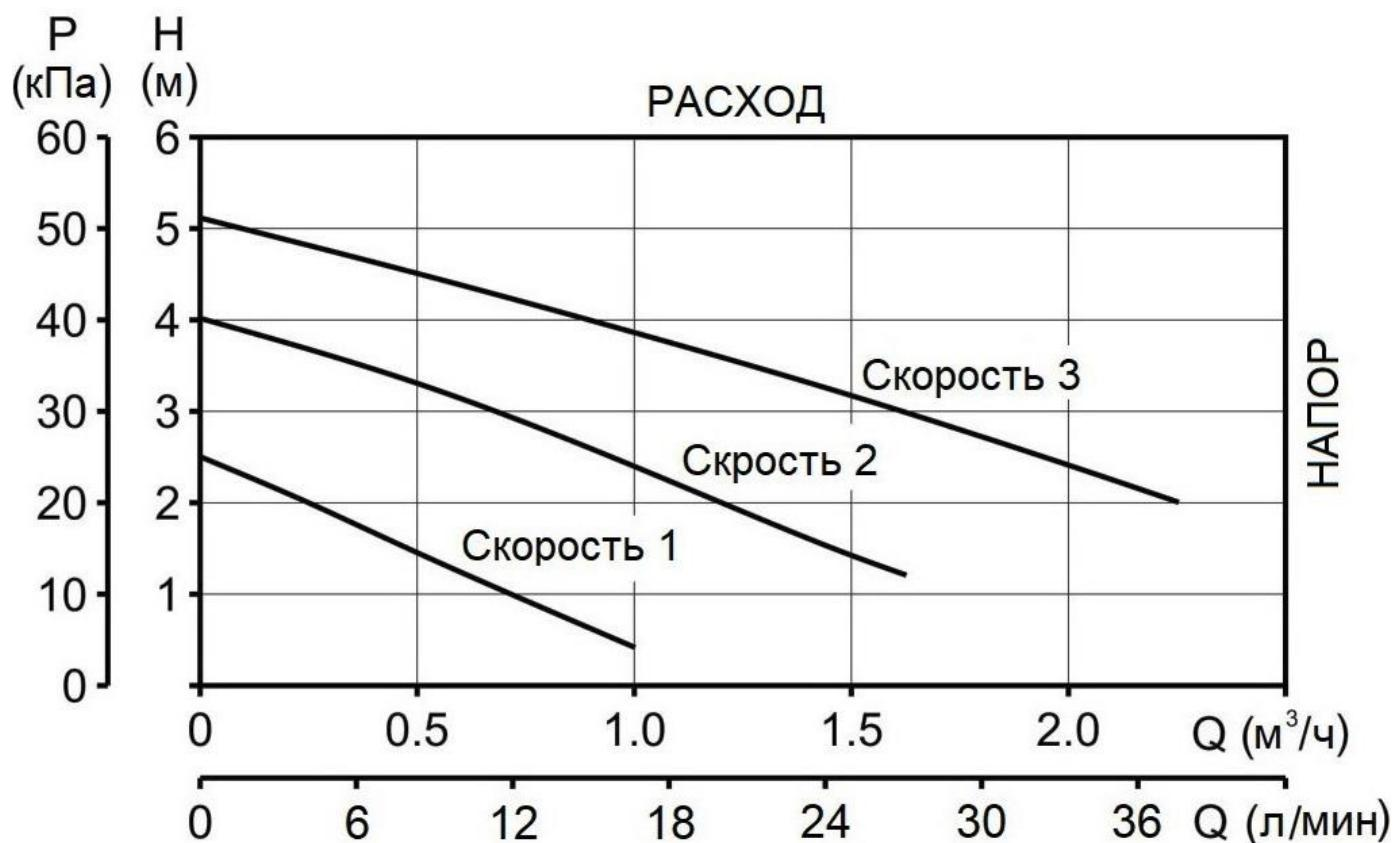
Рис. 17 Напорно-расходные кривые циркуляционного насоса электрокотла.
