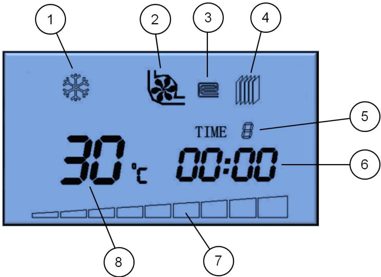
Рис. 7 ЖК-дисплей панели управления электрокотлом.
