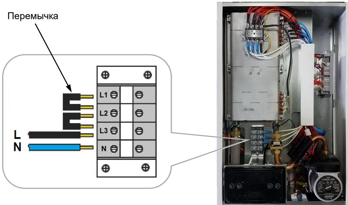
*Rис. 13 Однофазное подключение*
