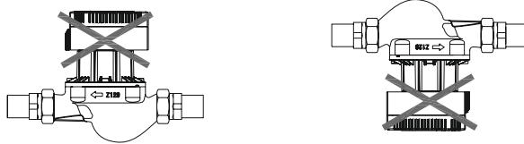
Рис.4 Недопустимое расположение вала насоса
